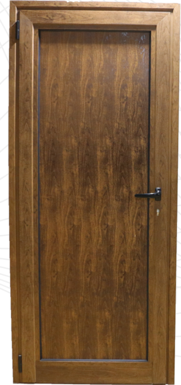
باب ألمنيوم مع شيت تلبيس ألمنيوم سماكة الألمنيوم 1.8 ملم , عرض الحلق ( 4.5 - 10.5 سم ) ,
