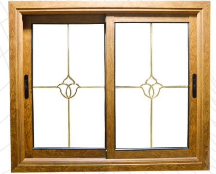
شباك دبل سرايا سحاب سماكة الألمنيوم 1.8 ملم , عرض الحلق ( 10-12 سم ) , الزجاج دبل 20 ملم
